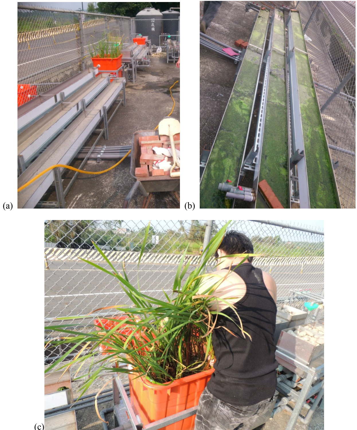
圖 4：(a) 植物床與藻床配置情形；(b)藻床運作情形；(c)植物床種植香蒲
