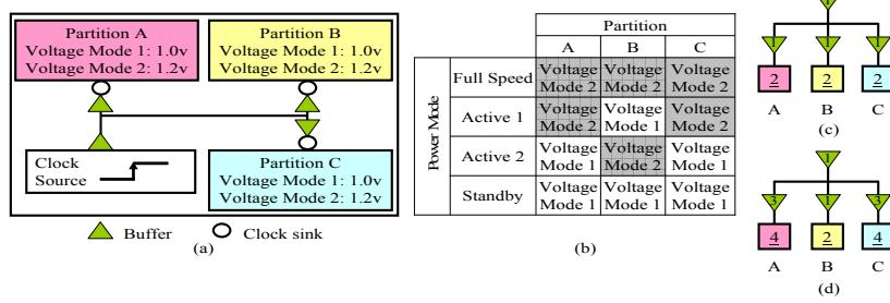
圖 3 (a)以 MDSV 方法設計之晶片，(b)各電壓島之電壓模式，(c)操作在全速模式時的時脈樹，(d)操作在 Active 2 模式時的時脈樹
