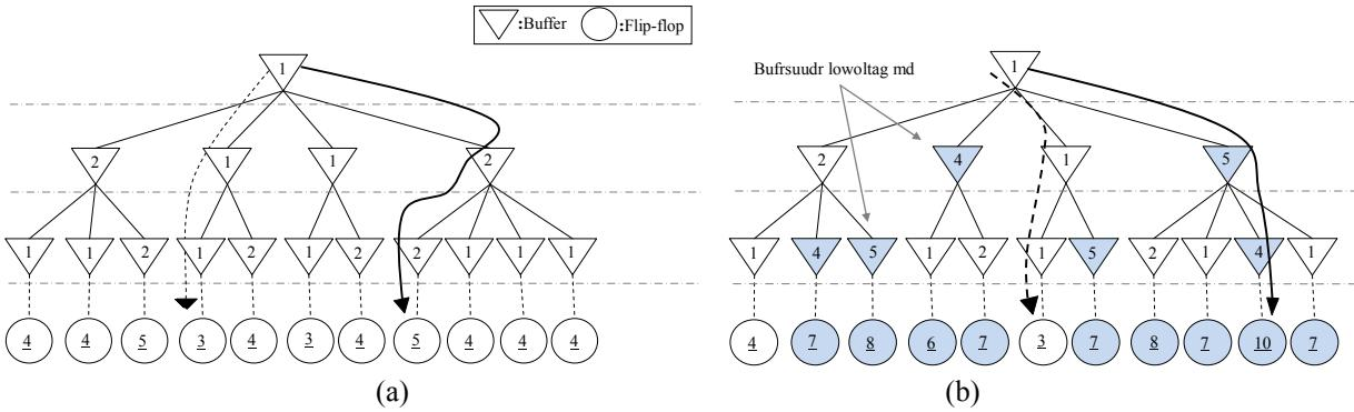
圖 6 當時脈樹在不同功率模式下的時序差異 (a)全速模式的時序差異為 2 個單位(符合時序差異的約定值)
