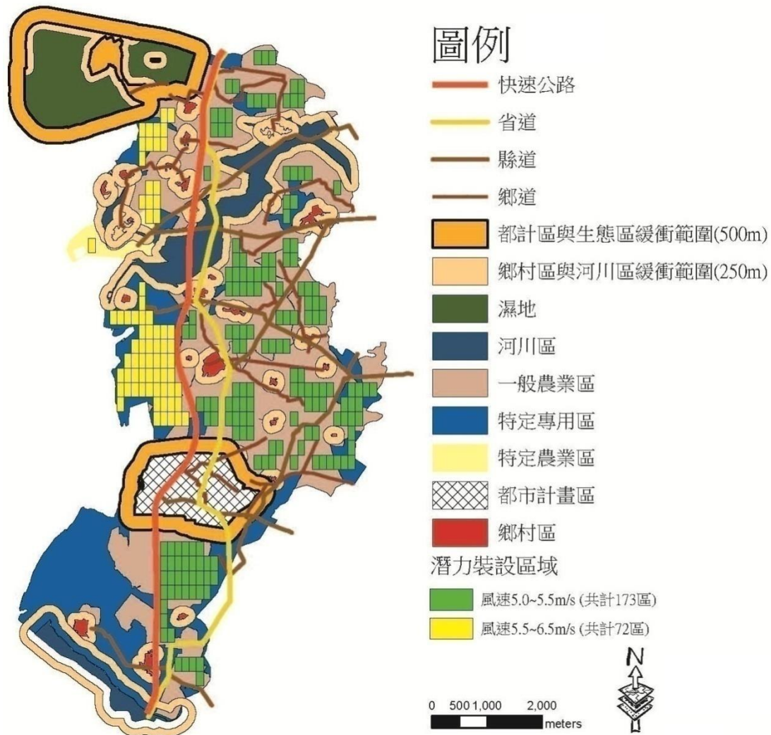
圖 2 扣除排除區後可裝設風機區域
