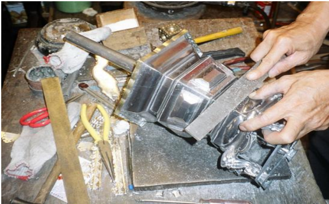
圖 3.4 銼修(圖由萬能錫鋪作者拍攝提供)
