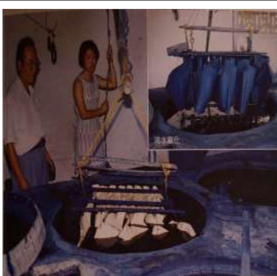
圖 3-3-16 傳統夾纈重複浸染氧化過程 圖片來源 111
