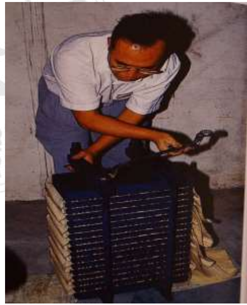
圖 3-3-15 成組夾板以夾具壓夾
