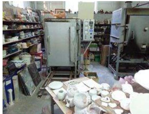
圖 3-38 窯爐與上釉後排燒的成品
