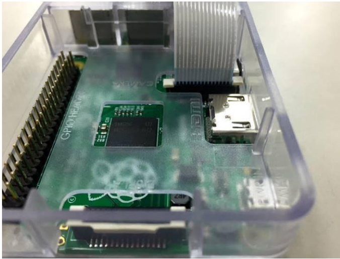
圖 2-3 相機排線安裝
