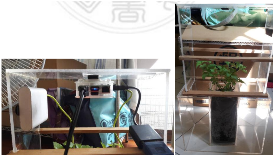
(a)樹莓派相機與其供電的行動電源配置 (b)固定植栽架
