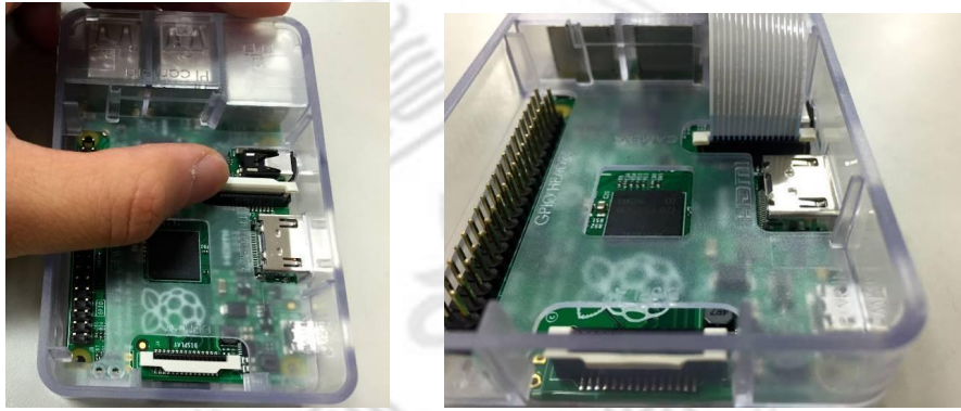
相機排線安裝
