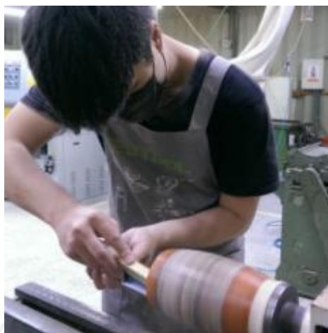
圖 4-31 木棒輔助砂磨內部（拍攝者：呂俊良）
