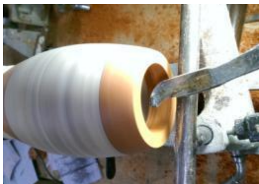
圖 4-49 車削內部 (拍攝者：呂俊良)
