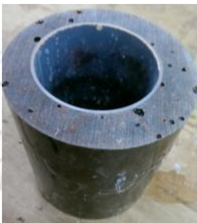
圖 4-110 砂磨後發現氣泡坑洞 (拍攝者：呂俊良)
