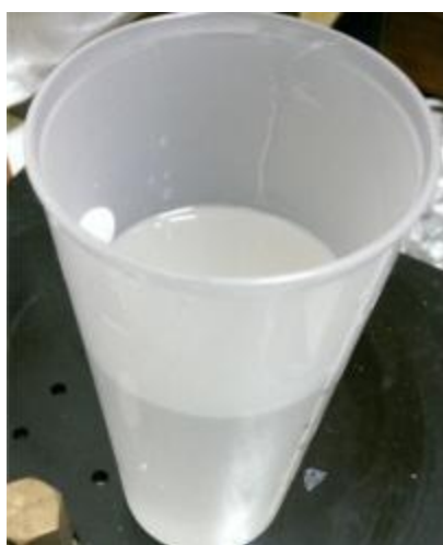
圖 4-5 環氧樹脂使用真空壓縮前（拍攝者：呂俊良）
