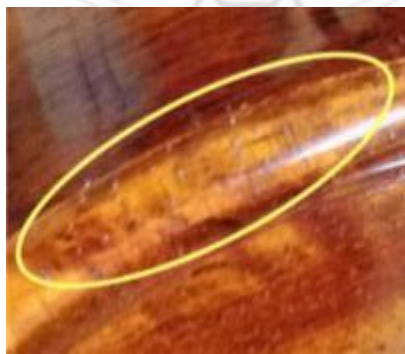
圖 4-7 未完全抽出的小氣泡 (拍攝者：呂俊良)
