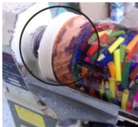
圖 4-23 增加夾板防止材料損壞
