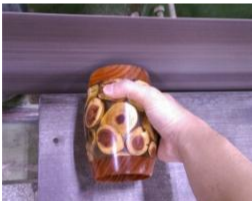
圖 4-57 側面砂帶機修飾（拍攝者：呂俊良）
