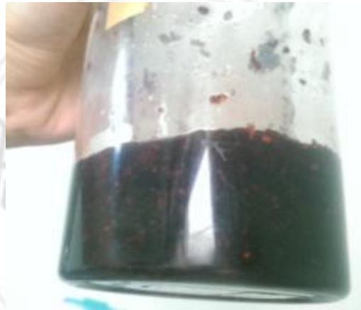
圖 4-94 氣泡排出使體積變少 (拍攝者：呂俊良)
