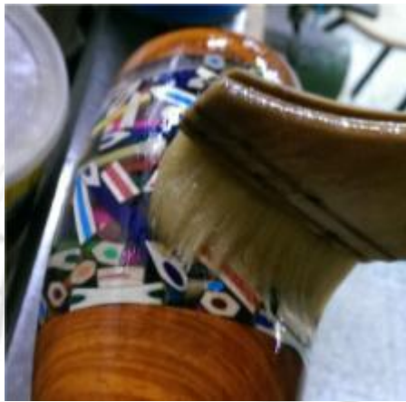
圖 4-34 塗裝底漆增色拋光 (拍攝者：呂俊良)
