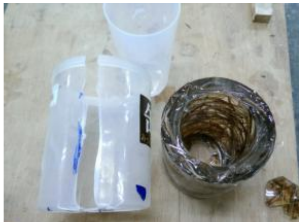
圖 4-78 取出固化的環氧樹脂 (拍攝者：呂俊良)
