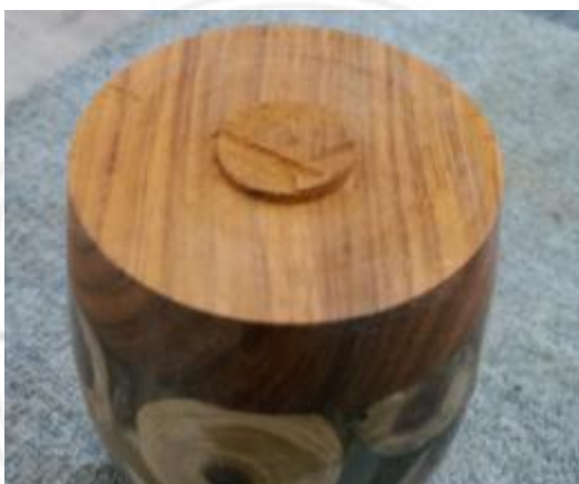
圖 4-56 底部鋸斷後的樣子（拍攝者：呂俊良）
