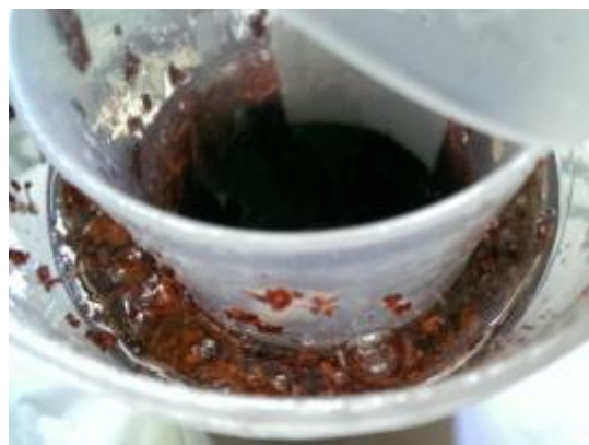
圖 4-108 火烤加熱使表面氣泡破裂 (拍攝者：呂俊良)
