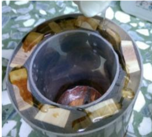
圖 4-41 脫模不易，直接上膠 (拍攝者：呂俊良)
