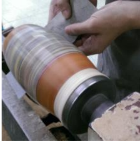
圖 4-33 使用棉布與蜂蠟拋光 (拍攝者：呂俊良)
