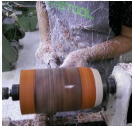
圖 4-47 曲面修飾、切削（拍攝者：呂俊良）
