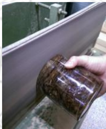
圖 4-80 砂磨瓶口與平底的黏接面 (拍攝者：呂俊良)
