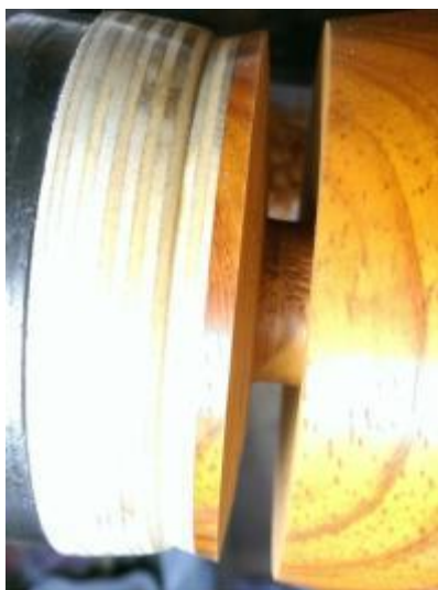
圖 4-73 分鑿車刀車出的縫隙（拍攝者：呂俊良）
