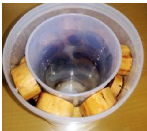
圖 4-39 模具上方檢視樹脂溢出有無 (拍攝者：呂俊良)
