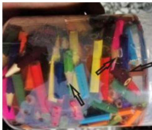
圖 4-17 三次灌注都發現未排出的氣泡 (拍攝者：呂俊良)
