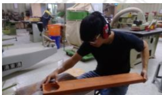
圖 4-11 使用線鋸機鋸切材料（拍攝者：呂俊良）
