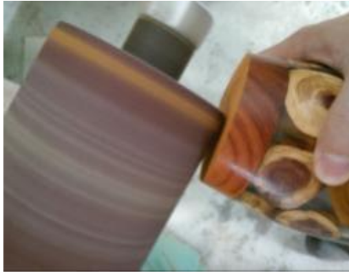
圖 4-58 氣鼓式砂磨機修飾 (拍攝者：呂俊良)
