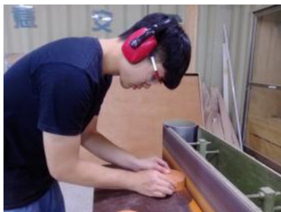
圖 4-12 使用側面砂帶修整材料（拍攝者：呂俊良）
