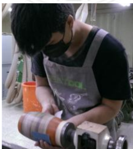
圖 4-32 使用高號數砂紙砂磨（拍攝者：呂俊良）
