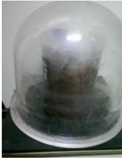
圖 4-76 使用真空幫浦機分四次灌注 (拍攝者：呂俊良)
