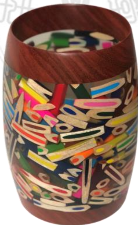
圖 4-37 環氧樹脂灌注與色鉛筆結合之容器 (拍攝者：呂俊良)
