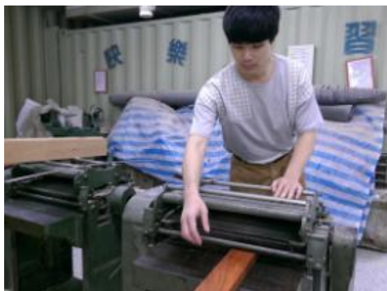
圖 4-10 使用平面鉋木機鉋削平面（拍攝者：呂俊良）
