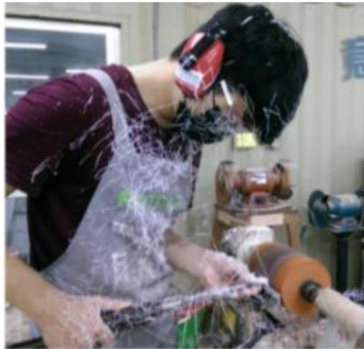
圖 4-46 表面車圓、刮削（拍攝者：呂俊良）
