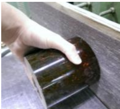
圖 4-109 砂磨平整 (拍攝者：呂俊良)
