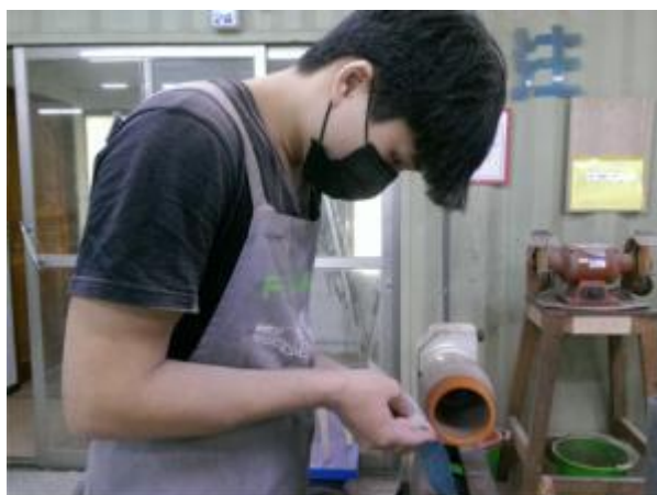
圖 4-72 表面砂磨 (拍攝者：呂俊良)
