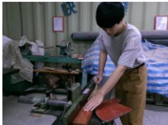
圖 4-9 使用手壓鉋木機鉋削平面（拍攝者：呂俊良）
