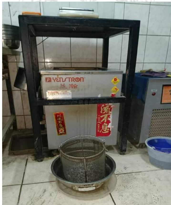
圖 3-7 粒料水中重試驗
