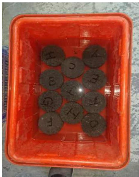
圖 3-15 試體浸水 24 小時
