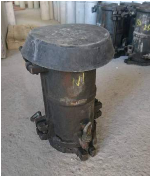
(i) 圓柱試體完成(蓋上保護蓋)
