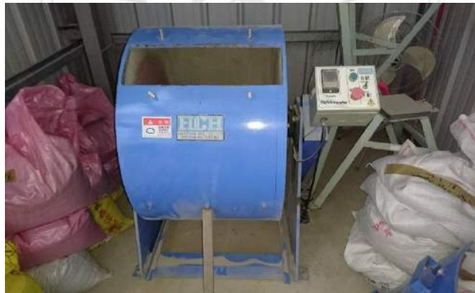
圖 3-8 洛杉磯磨損試驗
