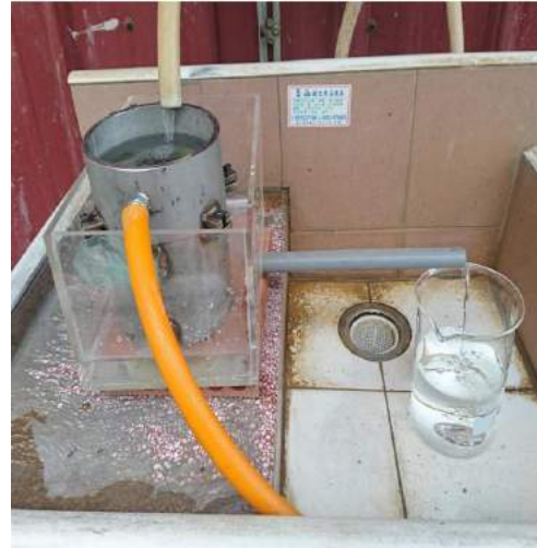
圖 3-14 試體透水測試
