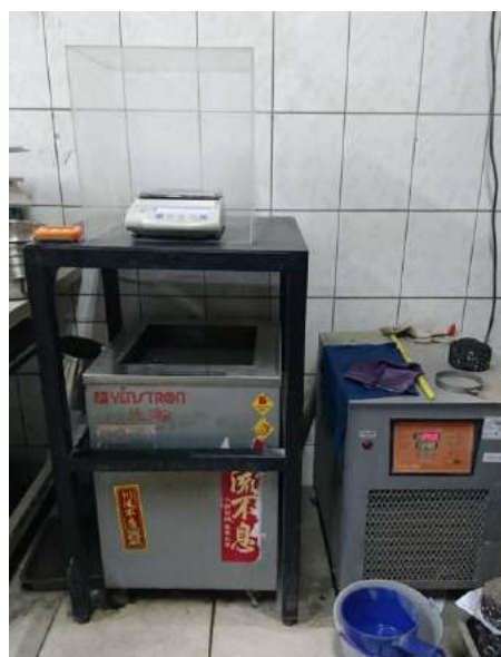
圖 3-16 試體水中體積試驗
