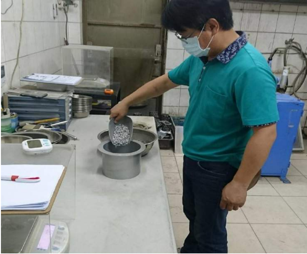
圖 3-9 粒料鏟填法試驗
