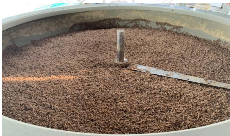
圖 5.1、溫度自動控制裝置（一次可投到 1000 公斤的餐廚餘）
