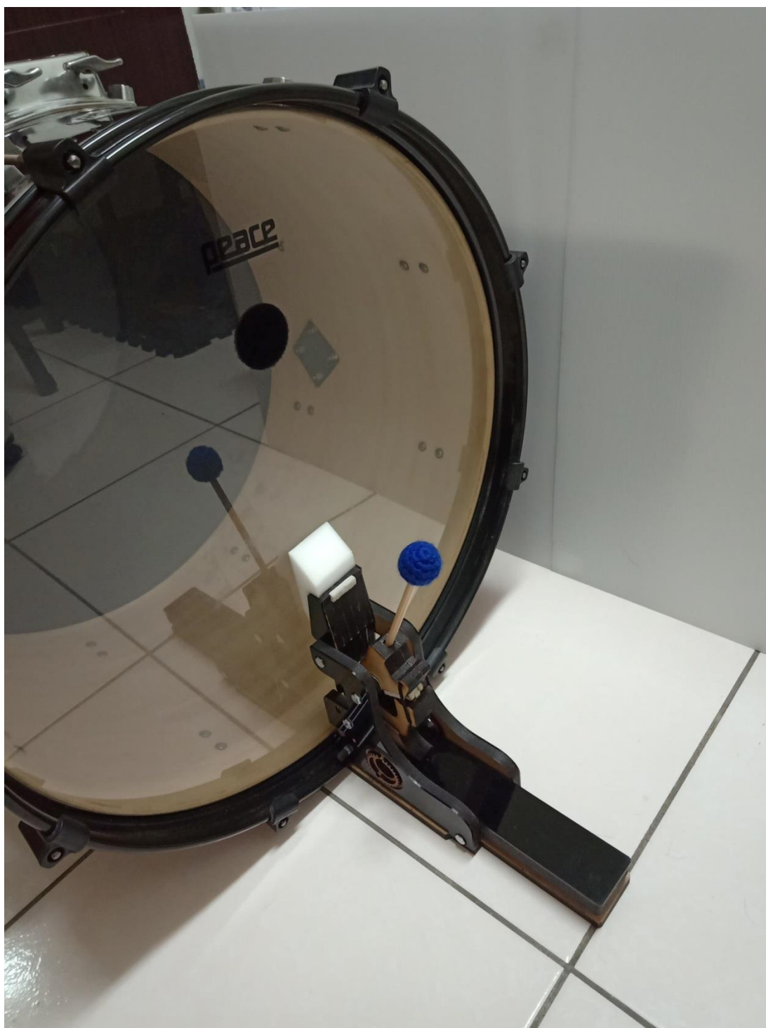
圖 4-8 此圖為止音式打槌系統鼓踏裝置於爵士鼓大鼓上(卓詩儒拍攝於 2020 年 8 月)
