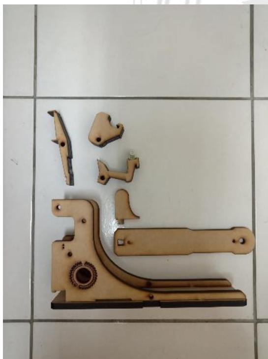
圖 3-18 此圖為止音式打槌系統鼓踏第五款的密集板材零件 (卓詩儒拍攝於 2020 年 5 月)
