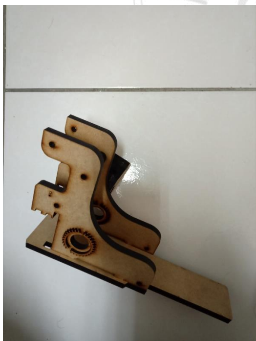
圖 3-29 此圖為止音式打槌系統鼓踏最終樣式的骨架(卓詩儒拍攝於 2020 年 8 月)
