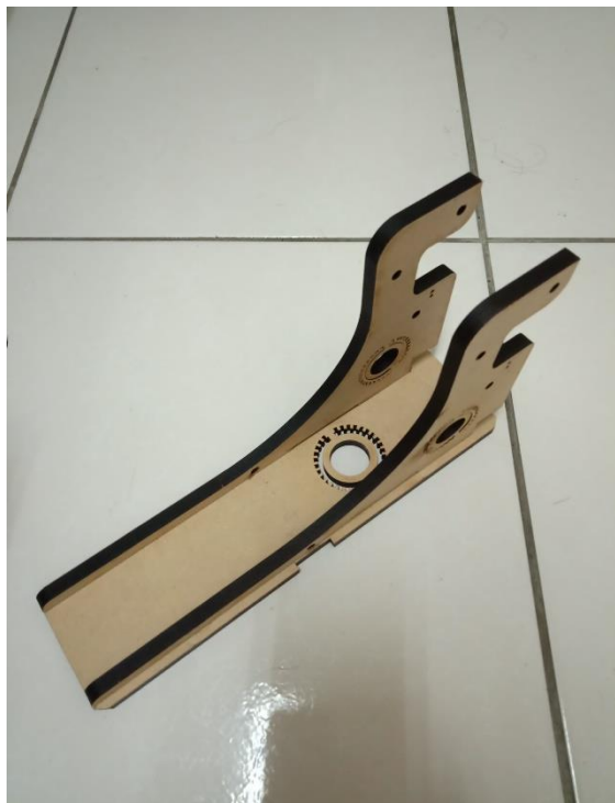
圖 3-17 此圖為止音式打槌系統鼓踏第五款的骨架 (卓詩儒拍攝於 2020 年 5 月)
