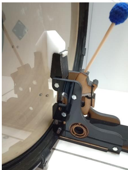
圖 4-3 此圖為止音式打槌系統鼓踏彈簧夾安裝說明(卓詩儒拍攝於 2020 年 8 月)
