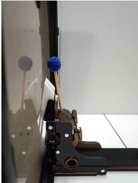
圖 4-4 此圖為止音式打槌系統鼓踏踩下踏板(卓詩儒拍攝於 2020 年 8 月)
