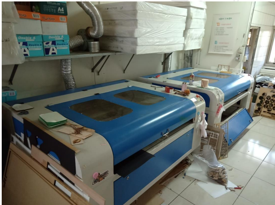
圖 3-16 此圖為雷射切割機，用於進行精密板材裁切 (卓詩儒拍攝於 2020 年 4 月)
