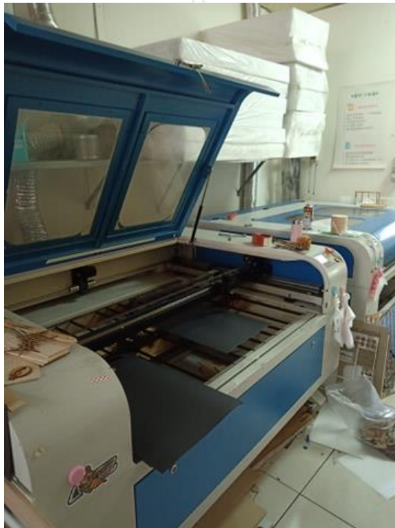
圖 3-8 此圖為雷射切割機，用於進行精密裁切(卓詩儒拍攝於 2019 年 8 月)
