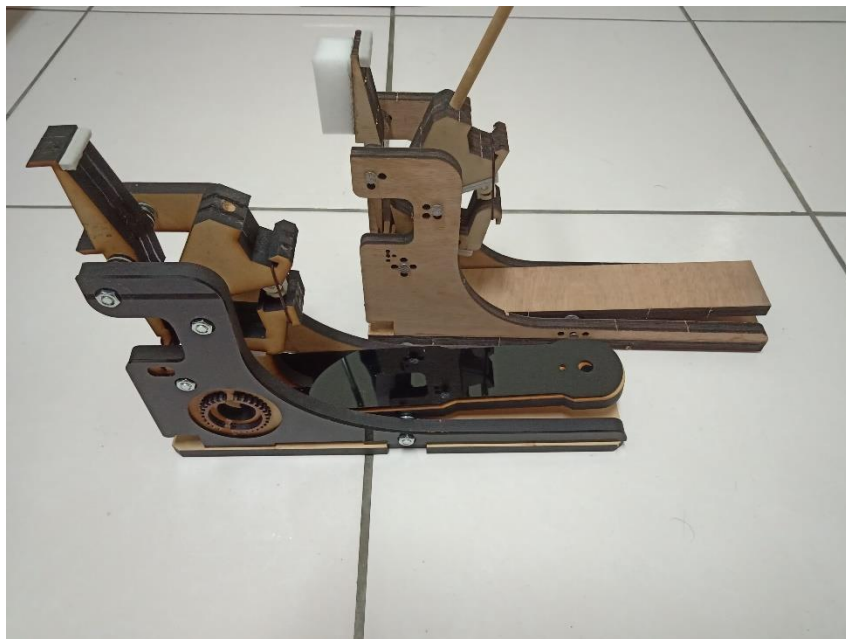
圖 3-19 此圖左方為止音式打槌系統鼓踏第五款的黑色壓克力安裝圖，右方為止音式打槌系統鼓踏第四款 (卓詩儒拍攝於 2020 年 5 月)
