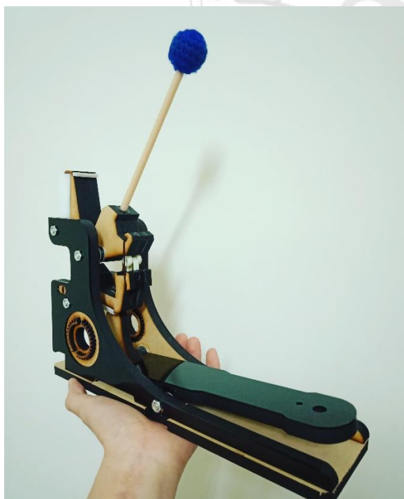
圖 3-20 此圖為止音式打槌系統鼓踏第五款的安裝完成圖 (卓詩儒拍攝於 2020 年 5 月)
