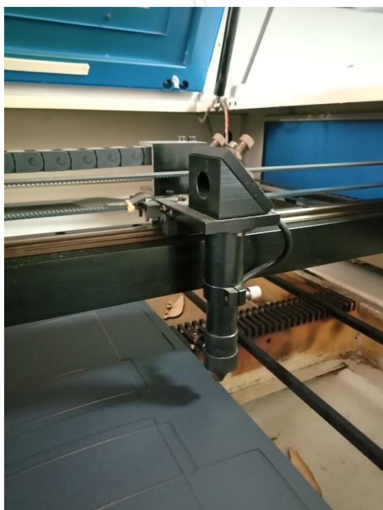
圖 3-27 此圖為雷射切割機內部的切割器(卓詩儒拍攝於 2020 年 7 月)
