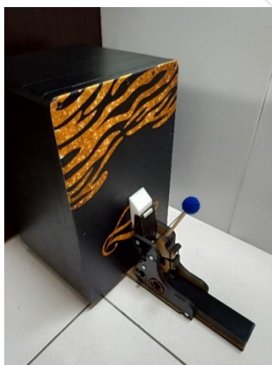
圖 4-7 此圖為止音式打槌系統鼓踏加裝木箱鼓專用固定架並將木箱鼓裝置於固定架上方(卓詩儒拍攝於 2020 年 8 月)
