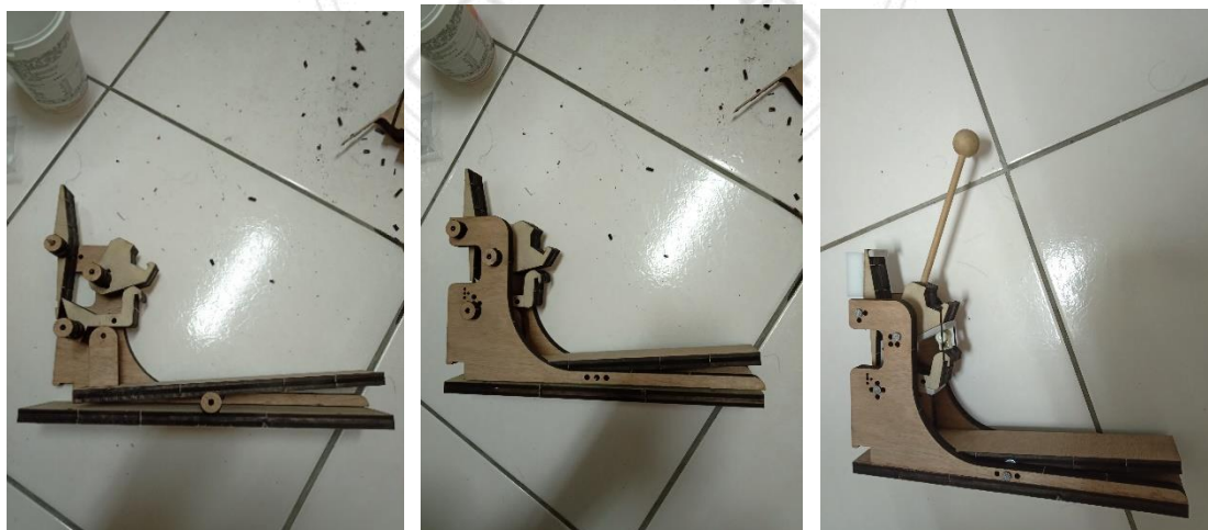
圖 3-10 此組圖為止音式打槌系統鼓踏第四款的實體組裝過程(卓詩儒拍攝於 2019 年 9 月)
