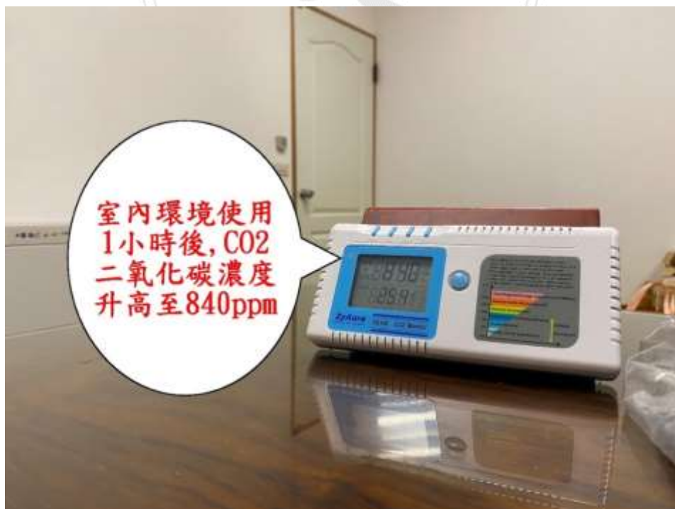
圖 4-4 實驗場域室內空間於使用經過 1 小時之後監測數據持續追蹤示範實驗場域空間於人員進入操作使用經過 2 小時之
