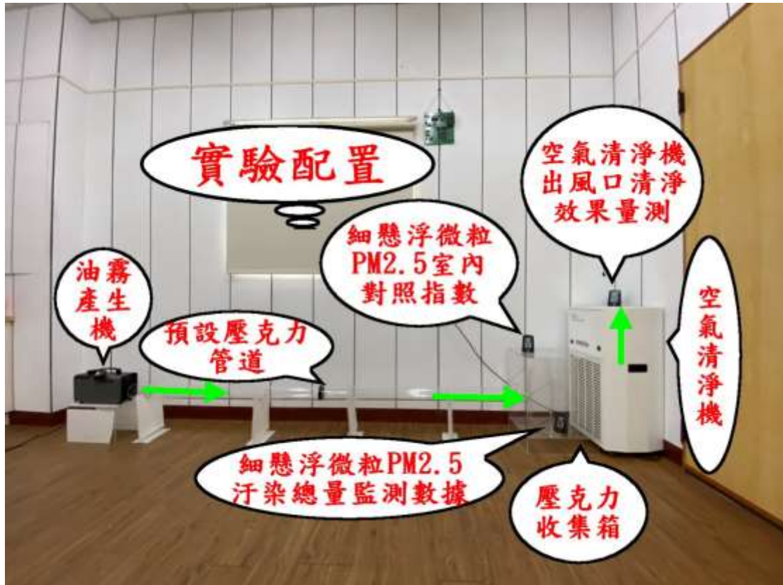
圖 3-20 實驗流程架構操作示意圖
