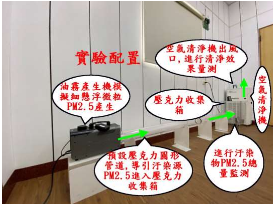
圖 3-18 實驗配置流程架構
