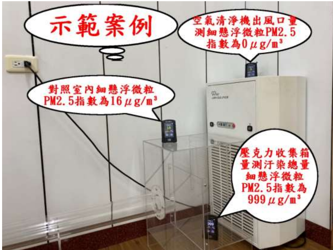
圖 3-21 示範案例空氣清淨機出風口檢測示意圖
