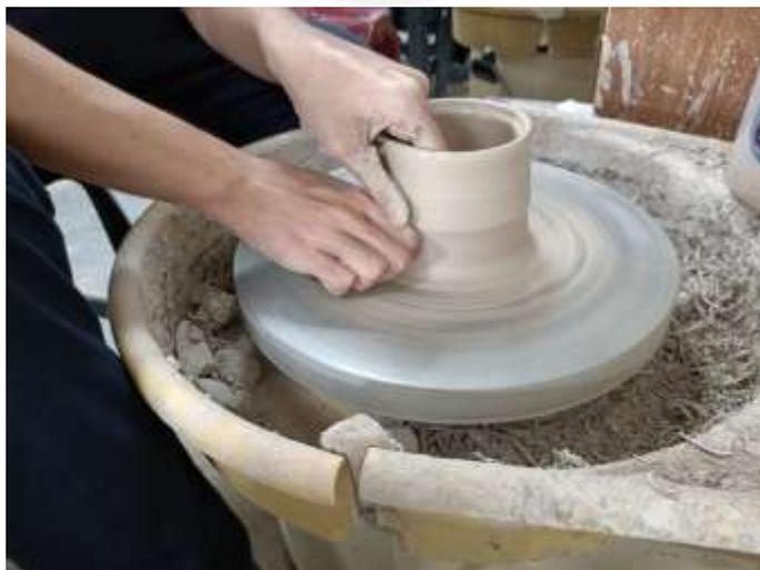
圖 2-16 運用拉高手法將坯體拉高(研究者攝)
