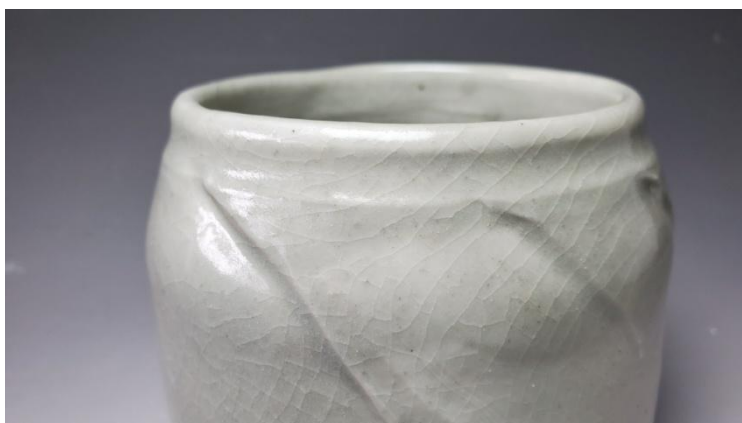
圖5-23 A-1配方，26號瓷土茶碗釉面細節 (研究者攝)
