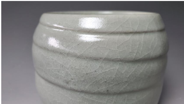
圖5-8 H-5配方，26號瓷土茶碗釉面細節 (研究者攝)
