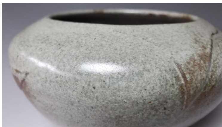
圖5-50 B-1配方，黃陶土水方釉面細節 (研究者攝)
