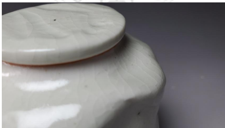
圖5-45 A-2配方，26號瓷土茶倉釉面細節-2 (研究者攝)
