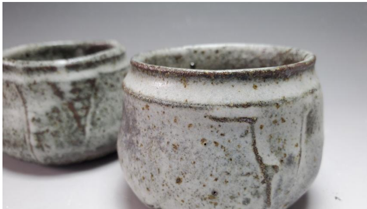
圖5-56 B-3配方，黃陶土品茗杯釉面細節 (研究者攝)
