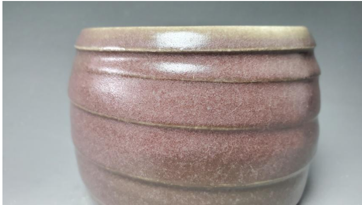
圖5-20 HCU-9配方，26號瓷土茶碗釉面細節 (研究者攝)
