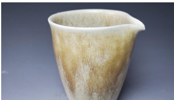
圖5-38 DTI-3配方，26號瓷土茶海釉面細節 (研究者攝)
