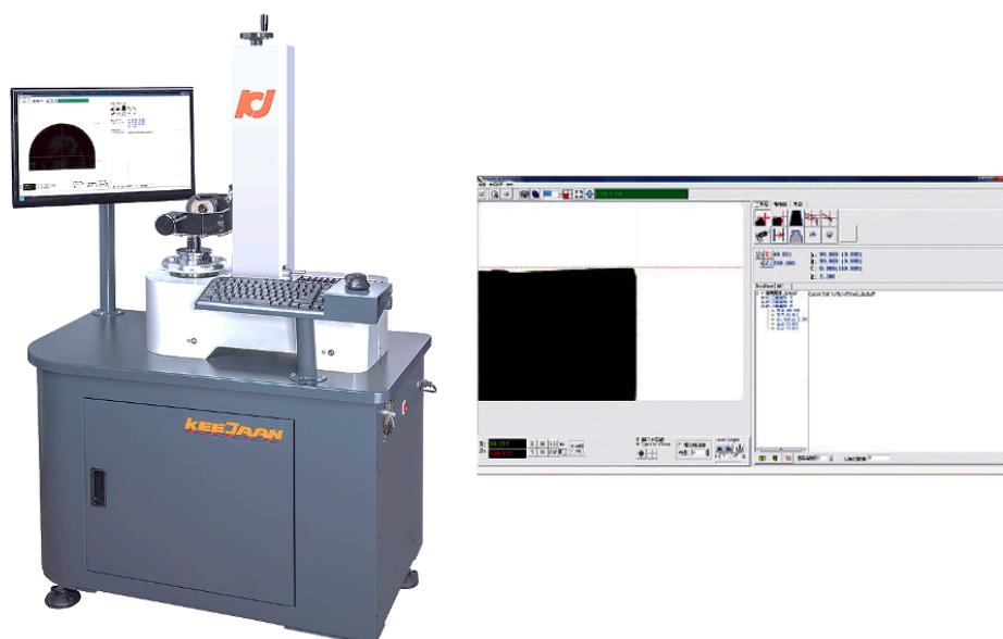
圖 5 刀具視覺檢測儀示意圖
