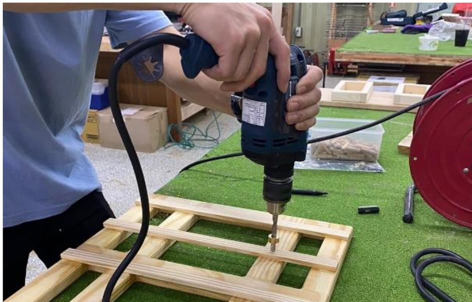
圖 4-4-62 使用手持電鑽配合鑽頭限位器進行打孔(研究者自攝)
