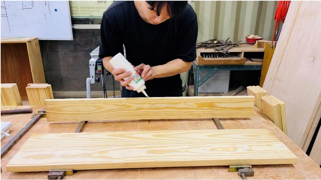
圖 4-4-6 材料拼接面上膠(研究者自攝)
