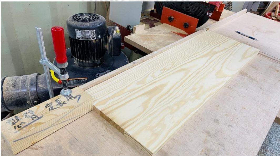
圖 4-4-56 使用懸臂機配合治具鋸切長度(研究者自攝)
