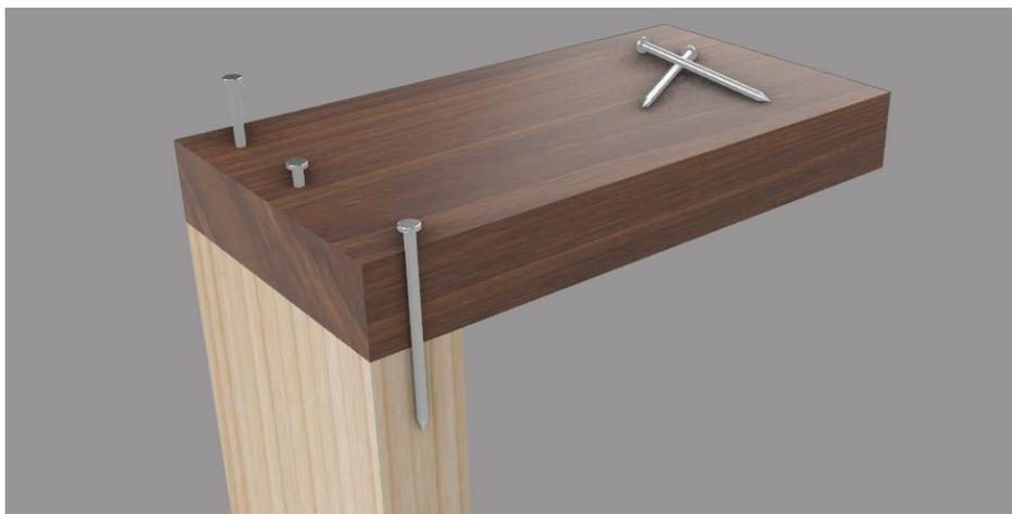
圖 2-5-1 釘接合示意圖(一) (研究者繪圖)
