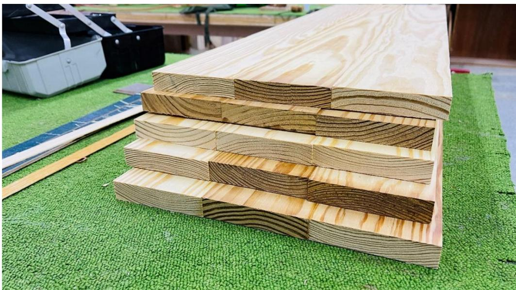
圖 4-4-12 卸除夾具後的材料與其斷面木紋方向（研究者自攝）
