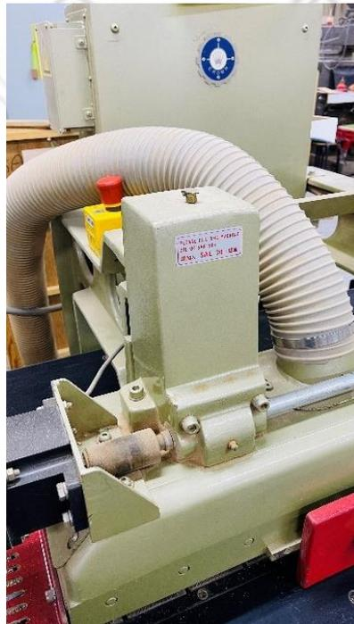
圖 3-1-8 縱切機緊急斷電鈕(研究者拍攝)
