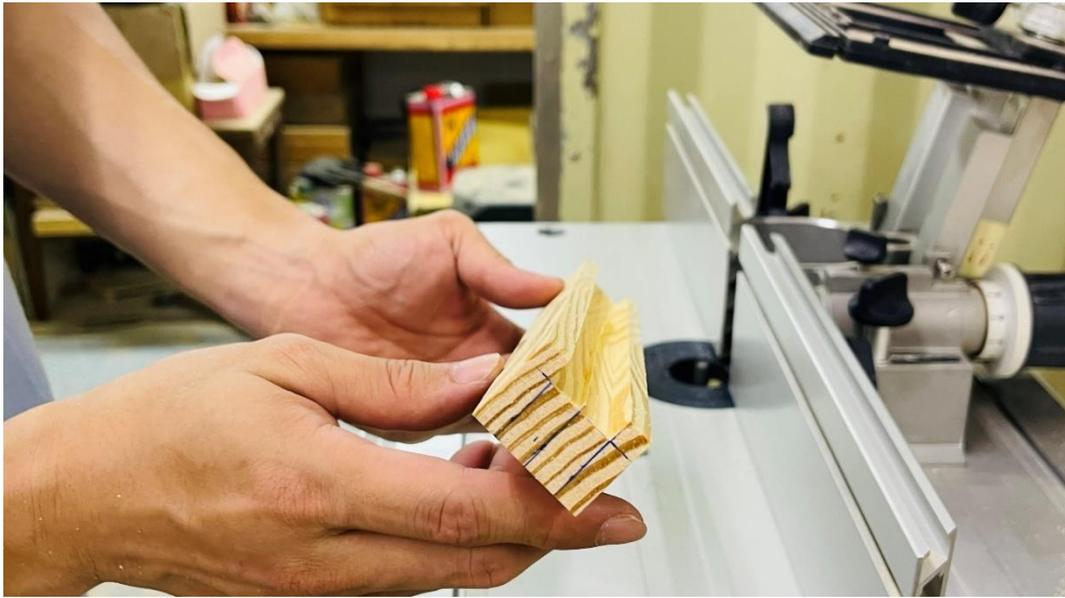
圖 4-4-40 斗拱結構-「升」部件開槽完成圖(研究者自攝)
