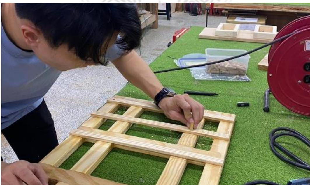
圖 4-4-63 鑽孔後的木釘試裝(研究者自攝)
