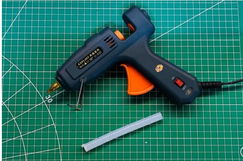
圖 3-2-3 熱熔膠槍與熱熔膠條(研究者拍攝)
