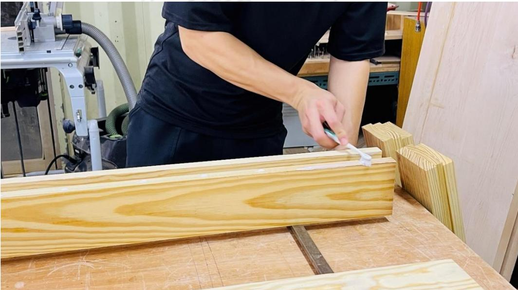
圖 4-4-7 材料拼接面上膠(研究者自攝)
