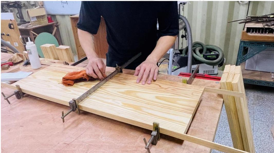
圖 4-4-11 拼板材料以夾具固定後溢膠擦除（研究者自攝）
