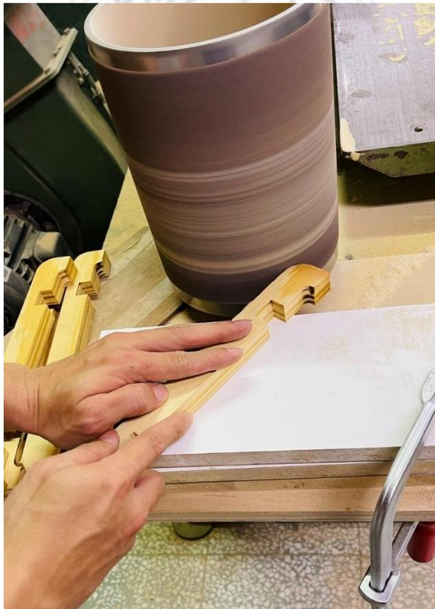
圖 4-4-51 使用砂帶機配合治具將材料多餘部分磨除 (研究者自攝)
