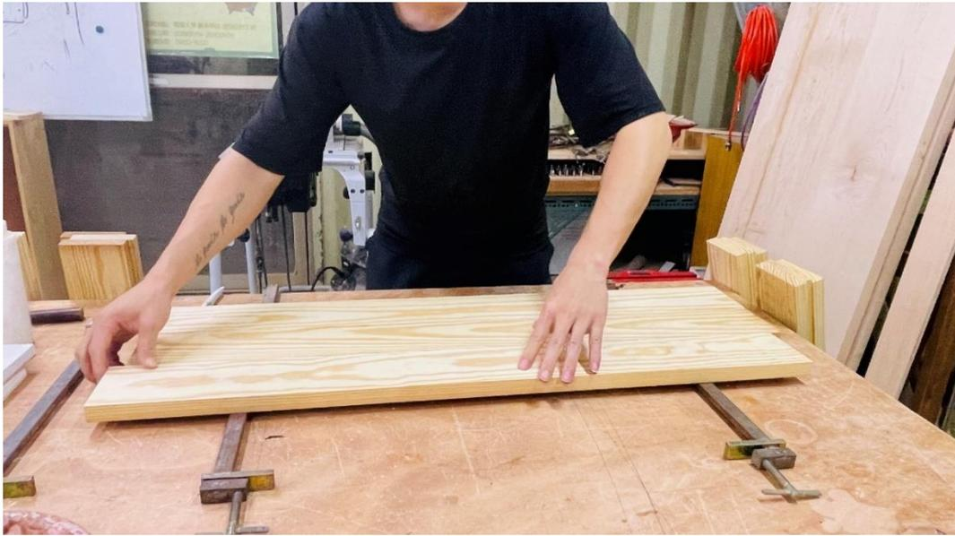
圖 4-4-8 材料拼板調整操作 (研究者自攝)
