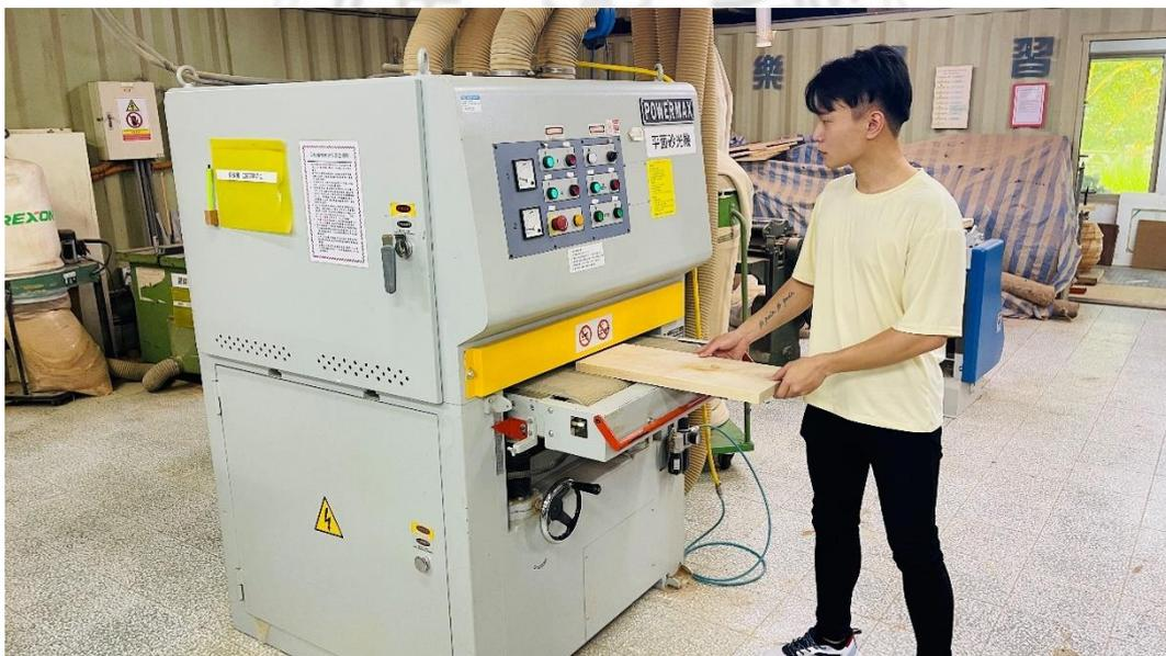
圖 4-4-13 拼板後的材料以平砂機整平平面（研究者自攝）
