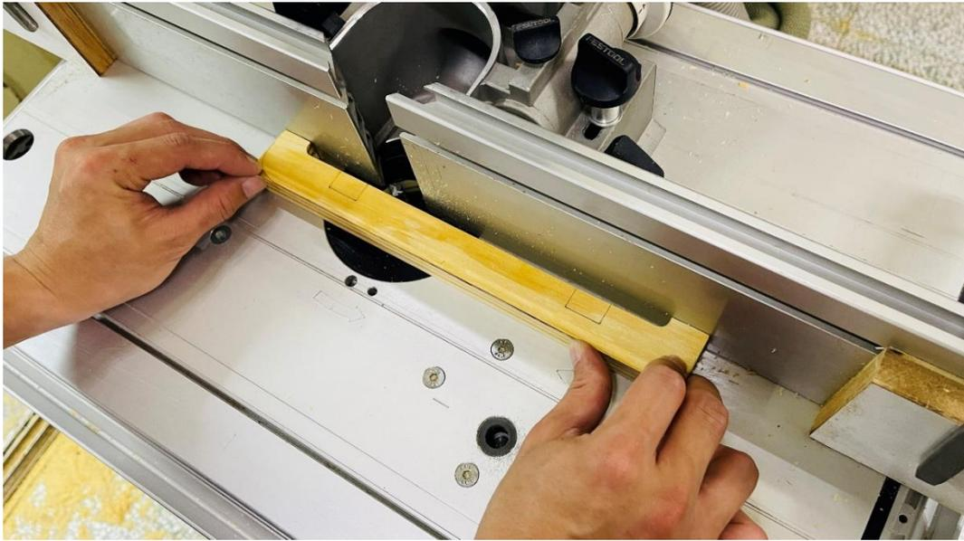
圖 4-4-46 使用木工修邊工作站進行材料修邊(研究者自攝)
