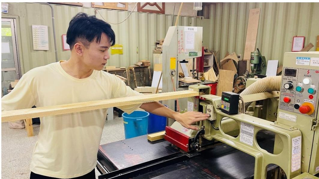
圖 4-4-17 縱開機材料高度調整(研究者自攝)
