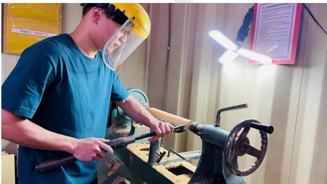
圖 4-4-60 使用車床車削圓柱(研究者自攝)
