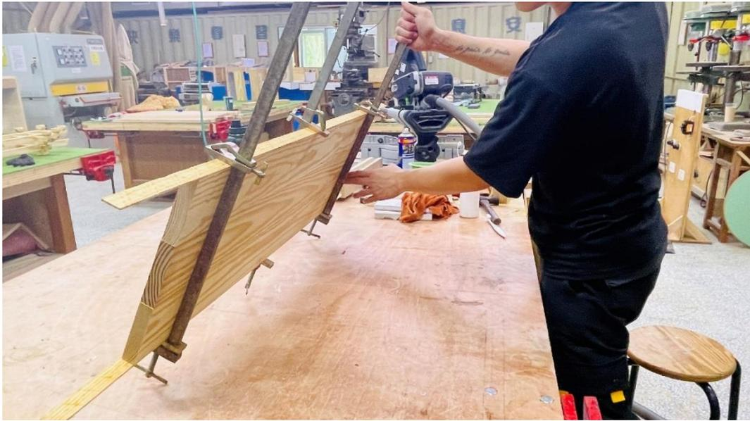
圖 4-4-10 以夾具固定材料後檢視平整度（研究者自攝）
