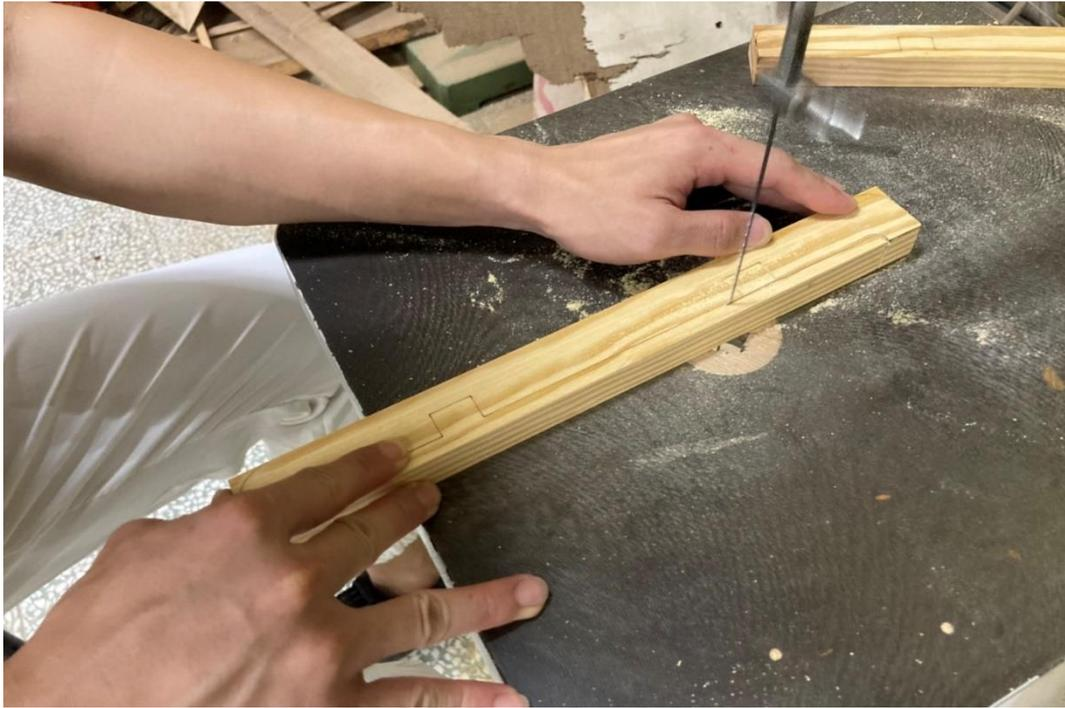
圖 4-4-44 使用線鋸機將多餘材料切除(研究者自攝)
