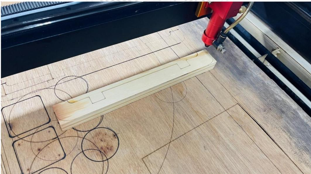
圖 4-4-43 使用雷射切割機進行 1:1 尺寸劃線(研究者自攝)
