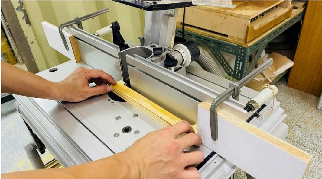
圖 4-4-45 使用木工修邊工作站配合限位治具進行材料修邊(研究者自攝)
