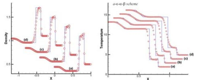
圖 1、Lax 震波管密度(左)與溫度(右)，(a)  $\beta = 0.01$ ，(b)  $\beta = 0.05$ ，(c)  $\beta = 0.1$ ，(d)  $\beta = 0.2$ 。
