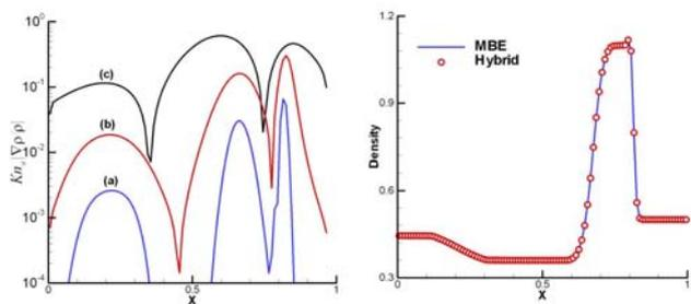
圖 4 稀薄度參數  $S_{Kn}$ ，圖 5 一體化解法驗證  $Kn_\infty$  (a)0.001(b)0.01(c)0.1
