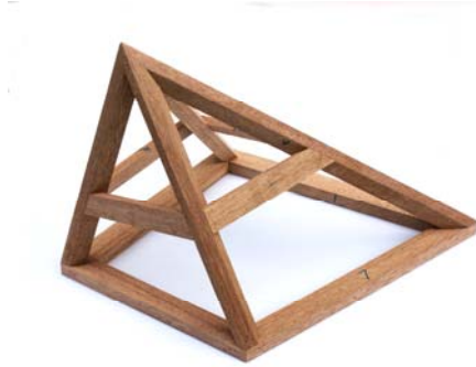
圖 37 實際製作完成的複斜木結構 (實作：鄭順福，攝影：周立倫)
