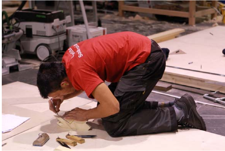
圖 1 建築木工選手辛苦的跪趴在夾板上繪圖及放樣。 (資料來源：WorldSkills London 2011 官網，2011)
