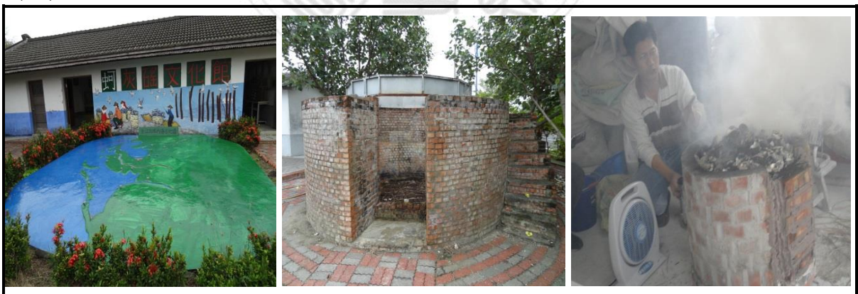
【圖 3-3-3】蚵殼灰的燒製過程照片 (研究者拍攝，2012)
