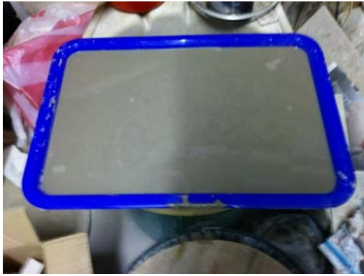
圖 5：香灰浸泡(24h)後置於托盤
