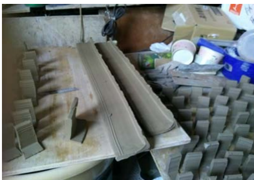
圖 1：擠壓成型 L 型土條
