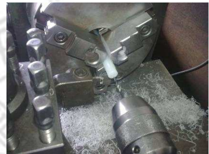
圖 3-3-7 鄧漢聰，〈指揮家〉絕緣塑膠車床加工圖
