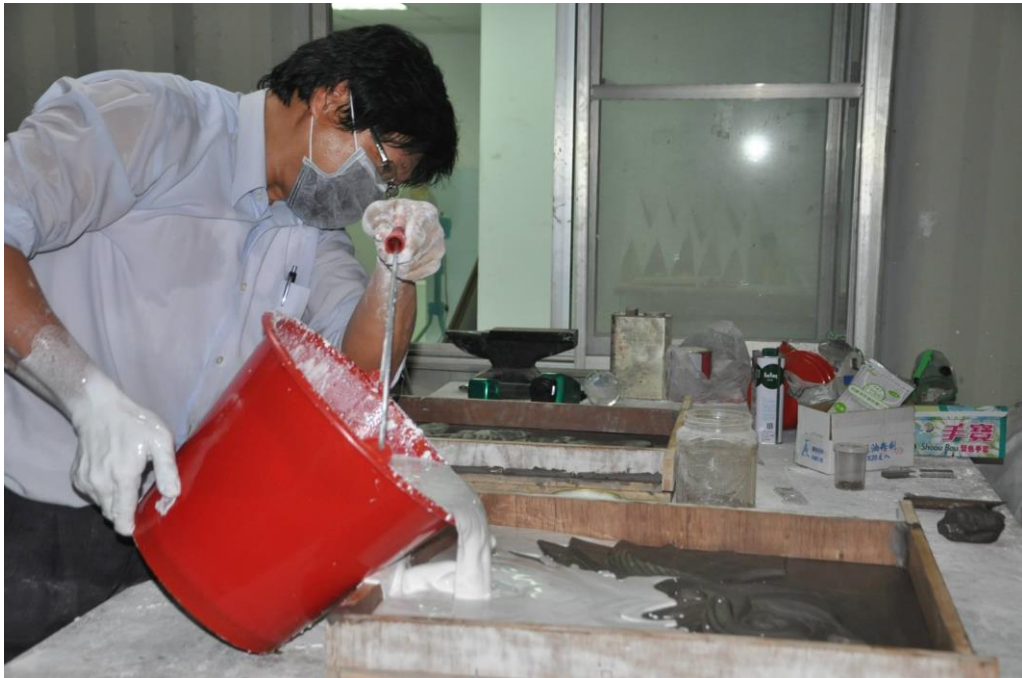
圖 3-14 原型翻製 FRP(玻璃纖維強化塑膠)操作圖 2，灌注石膏
