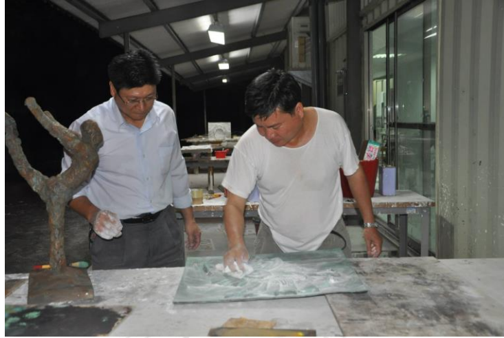
圖 3-20 原型翻製 FRP(玻璃纖維強化塑膠)操作圖 8，施以滑石粉，使其更具仿古作用
