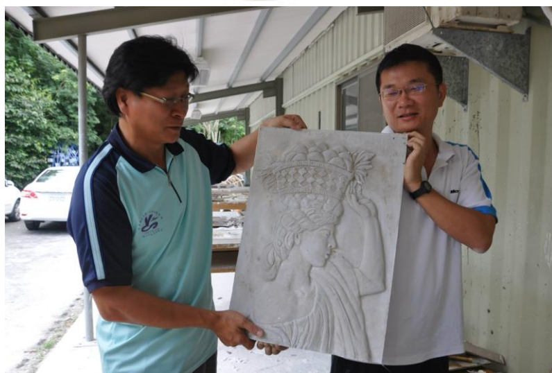
圖 3-17 原型翻製 FRP(玻璃纖維強化塑膠)操作圖 5，F.R.P 成型
