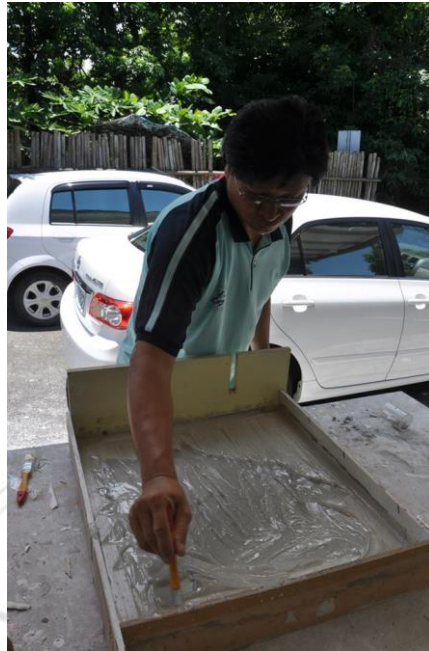
圖 3-16 原型翻製 FRP(玻璃纖維強化塑膠)操作圖 4，由石膏模再翻製 F.R.P
