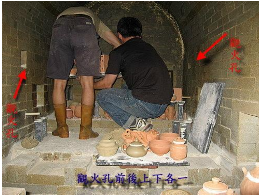
圖 3-8 筆者工坊的柴燒窯，觀火孔前後上下各一個
