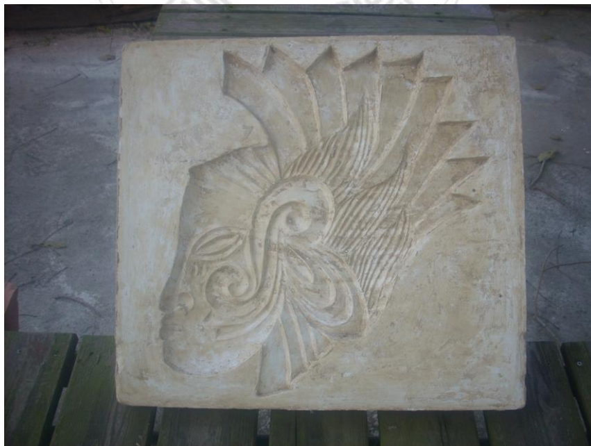
圖 3-15 原型翻製 FRP(玻璃纖維強化塑膠)P 操作圖 3，石膏模成型
