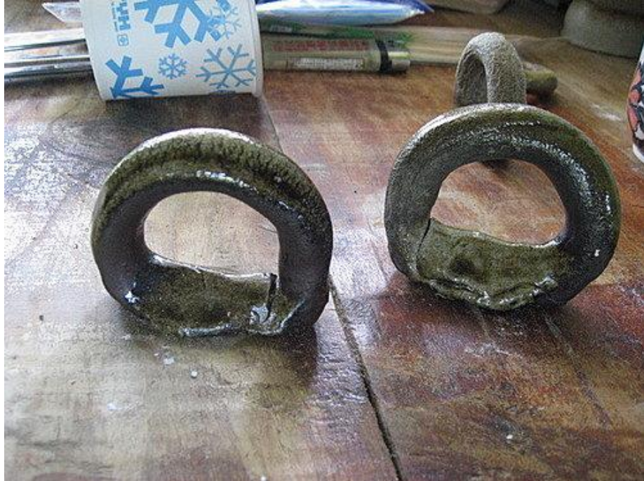
圖 3-10 冷卻後的試片，從試片的成色可以看出高溫時窯內的氣氛，更能藉此判斷此時窯內的溫度
