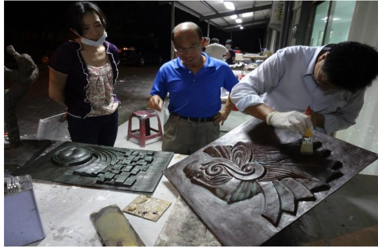
圖 3-18 原型翻製 FRP(玻璃纖維強化塑膠)操作圖 6，上色
