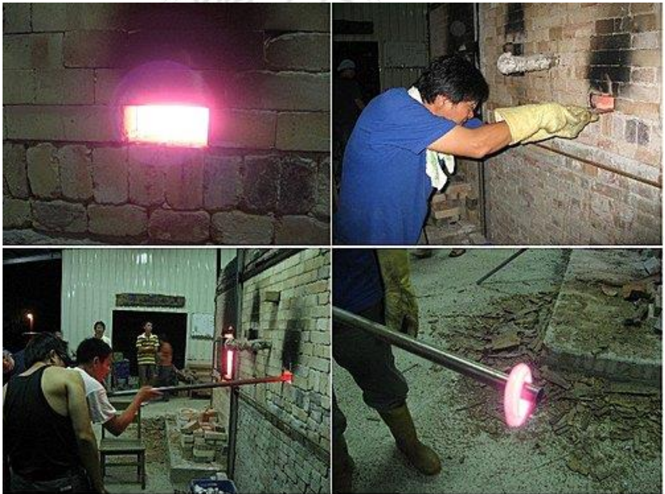
圖 3-9 窯內高溫挑出試片操作圖，柴燒高溫時從觀火孔挑出試片
