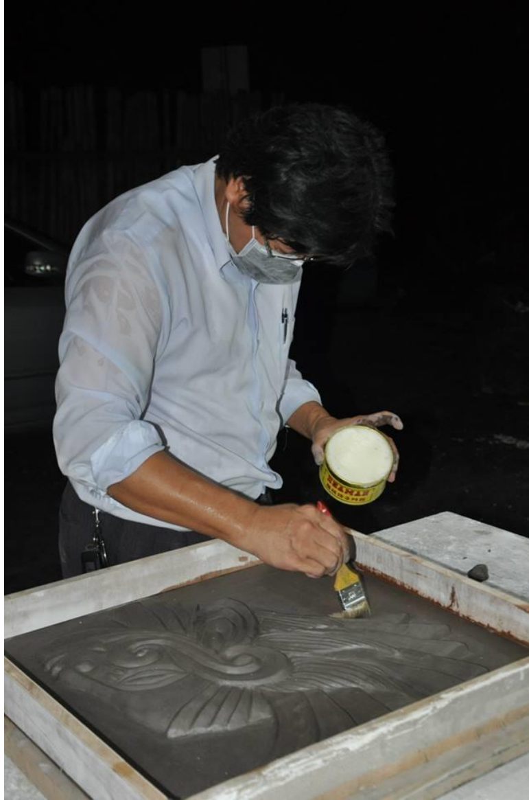
圖 3-13 原型翻製 FRP(玻璃纖維強化塑膠)操作圖 1，原型塗隔離劑，以便脫模
