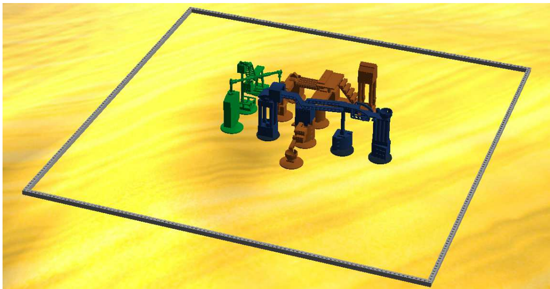
圖4.7正矩形可利用廠房空間最佳佈置3D模擬示意圖
