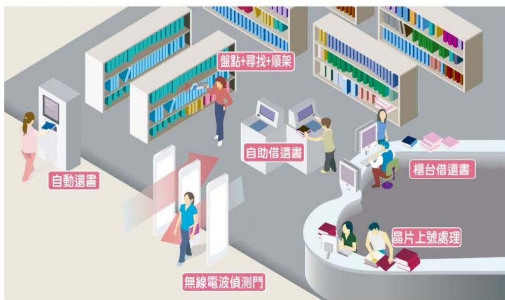
圖 1.6 無線射頻圖書館藏管理系統設備示意圖
