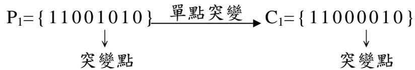
圖 2-4 二進制位元突變法示例
