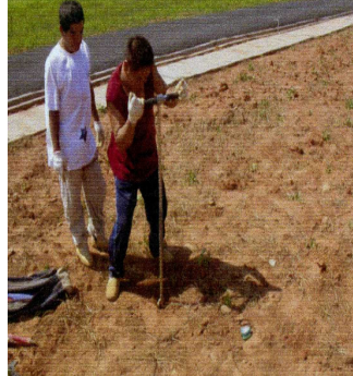
圖 4-2-178 人力鑽孔取土
