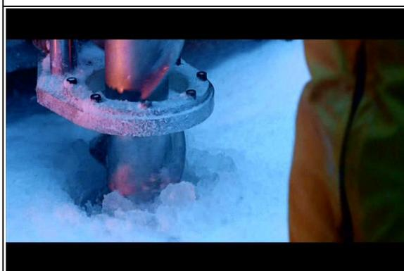
圖表 24 冰芯探測，鑽勘取得冰芯。
