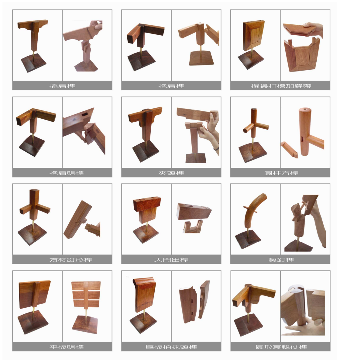
(圖五-6 永興木製榫卯拆解圖 資料來源：台南·家具產業博物館，本資料彙整)
