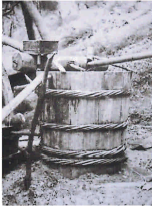
【圖1-01】蛇管式冷卻器 (苗栗縣文化局網站)
