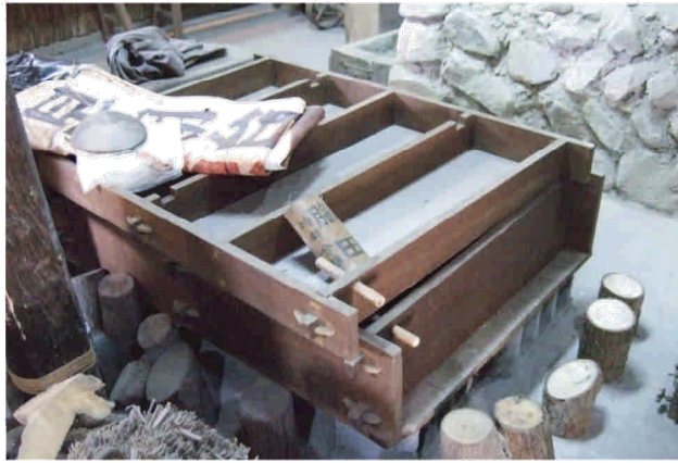
【圖1-02】箱式腦田；上層為冷卻槽下層則為分離槽，適用於本樟的生產(筆者，2006，花壇 腦寮間)
