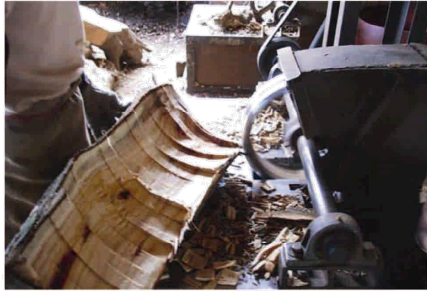
【圖4-07】「機器鋒仔」削取樟木片的實作情形（筆者，2006，苗栗銅鑼鄉 東華製腦廠）
