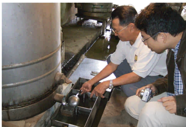
【圖1-08】吳騰金先生解說樟腦油經由冷卻筒進入分離槽後，油水分離的過程（同圖1-04）
