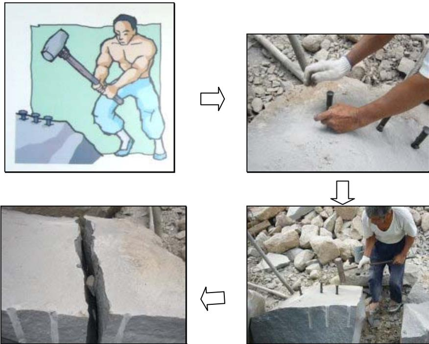
圖 2-1 採石流程復原圖
