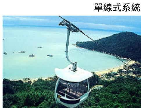
圖 4-3 循環式空中纜車系統圖
