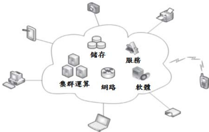
圖 2.1 雲端運算的基本架構圖
