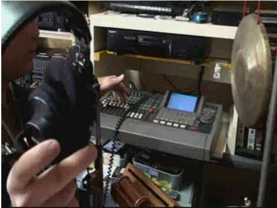
圖 4-10 混音器操作。使用混音器錄音，王文生把圖左的耳機開很大聲讓筆者可以聽到，王文生按下一個按鈕之後開始有了布袋戲的音響，王文生把混音器上面前六個有使用到的按鈕都往上推，接著王文生把混音器上左邊屬來第三到第六個按鈕往下推，筆者聽的是沒有音樂只有口白的，王文生再把剛剛往下拉的按鈕在往上推回去，筆者聽到先前的音響效果又出現了，所以各種聲音效果是分開來的。王文生家中三樓錄音室，2009/1/15 下午，攝影機影音擷取照片，陳音如攝影。
